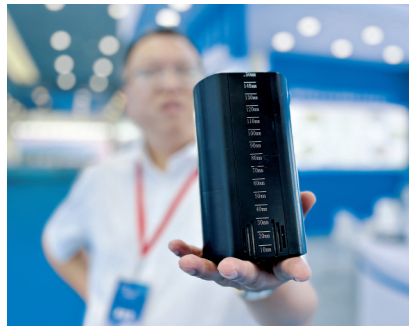
新型贴壁式积水监测终端外形小巧,适合安装在马路路缘。宋磊 摄
