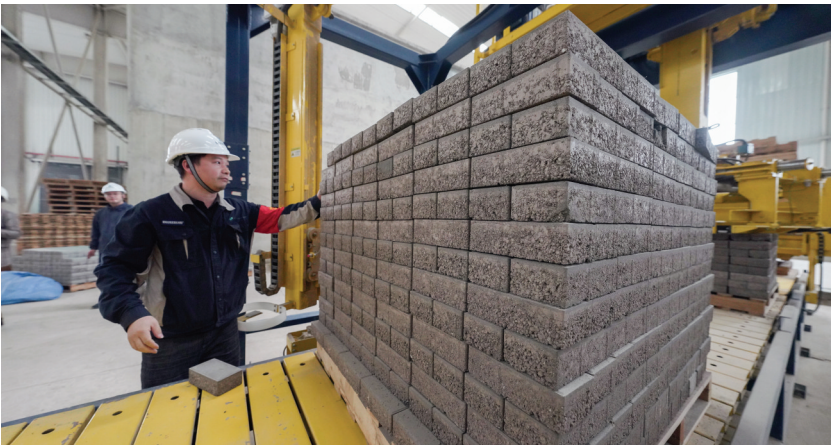
建筑垃圾被处理成透水砖,回用于城市建设。 通讯员殷超 摄
