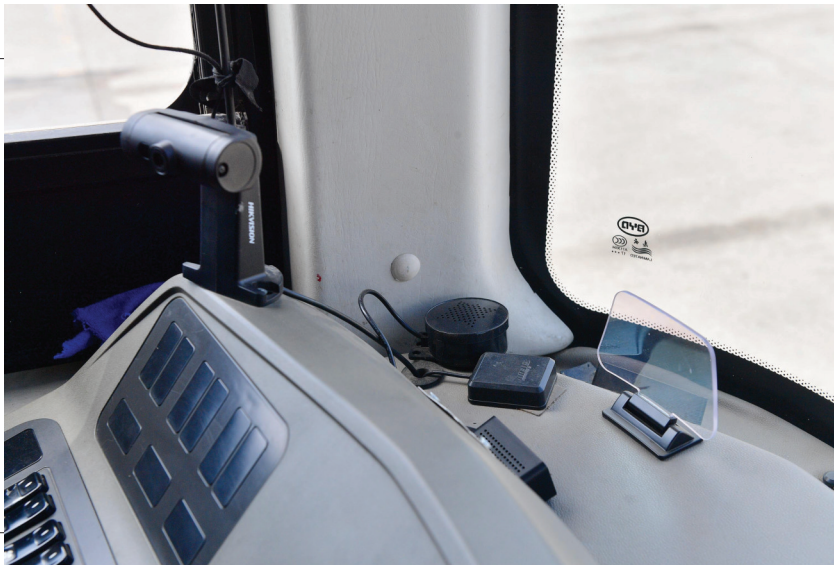
△车辆正前方安装的道路巡检设备。
