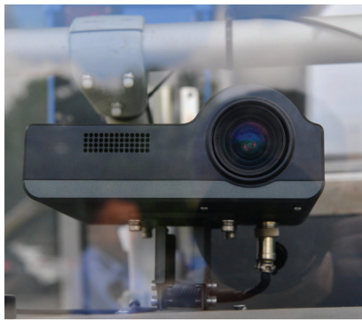
△车辆正前方安装的道路巡检设备。
