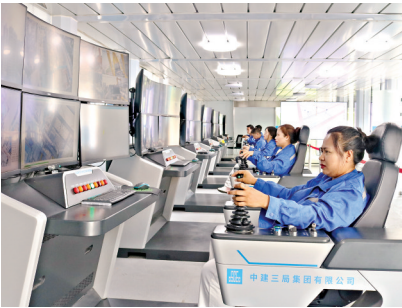
塔机控制室从塔机顶部搬到办公室里。
