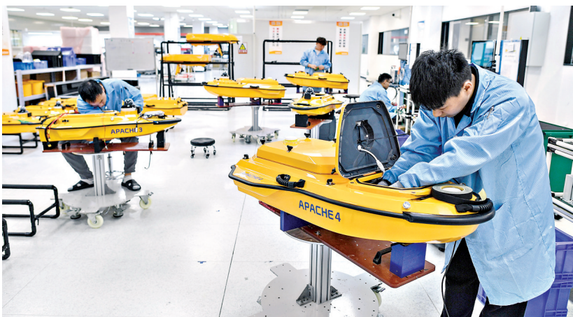
武汉华测车间内,技术人员在组装北斗无人化自动测量船。
