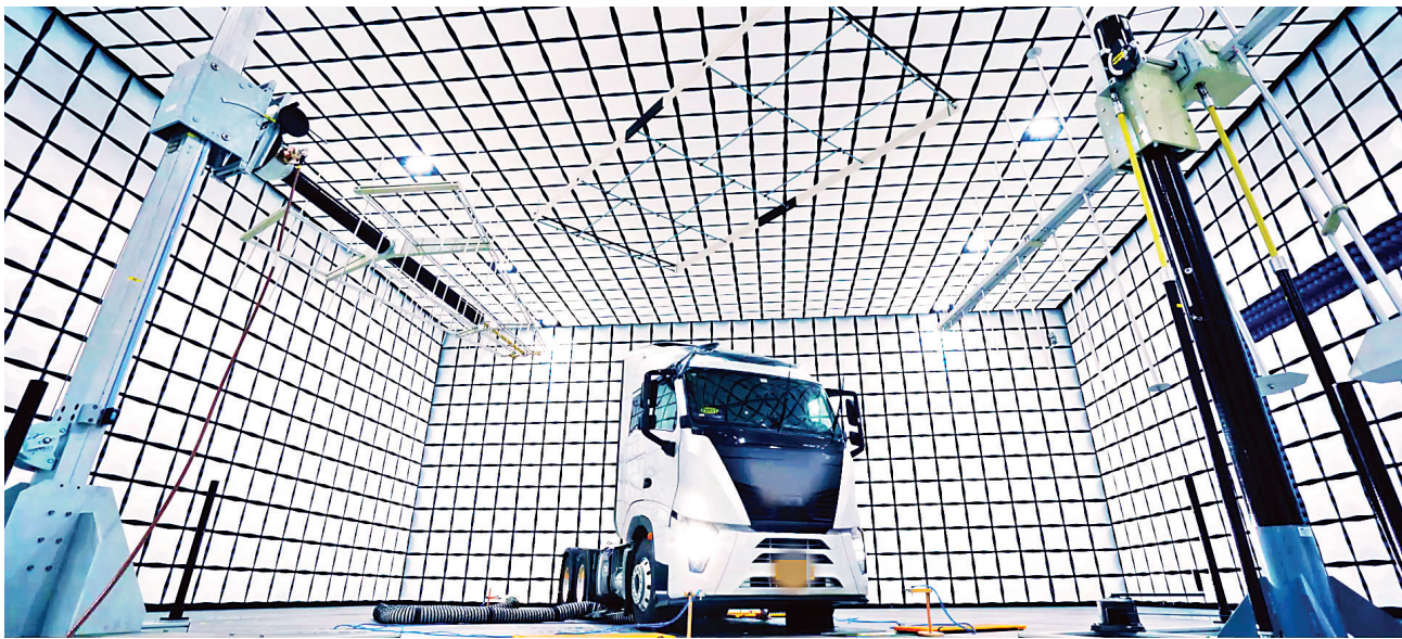
武汉检验中心内,车辆进行电磁兼容性测试。
