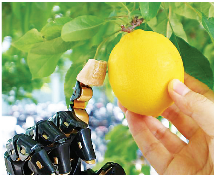
仿生三维电子皮肤在触摸柠檬感知其软硬程度。
