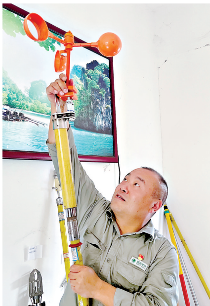
陶远东演示自己发明的“自动带电安装驱鸟器工具”工作原理。
