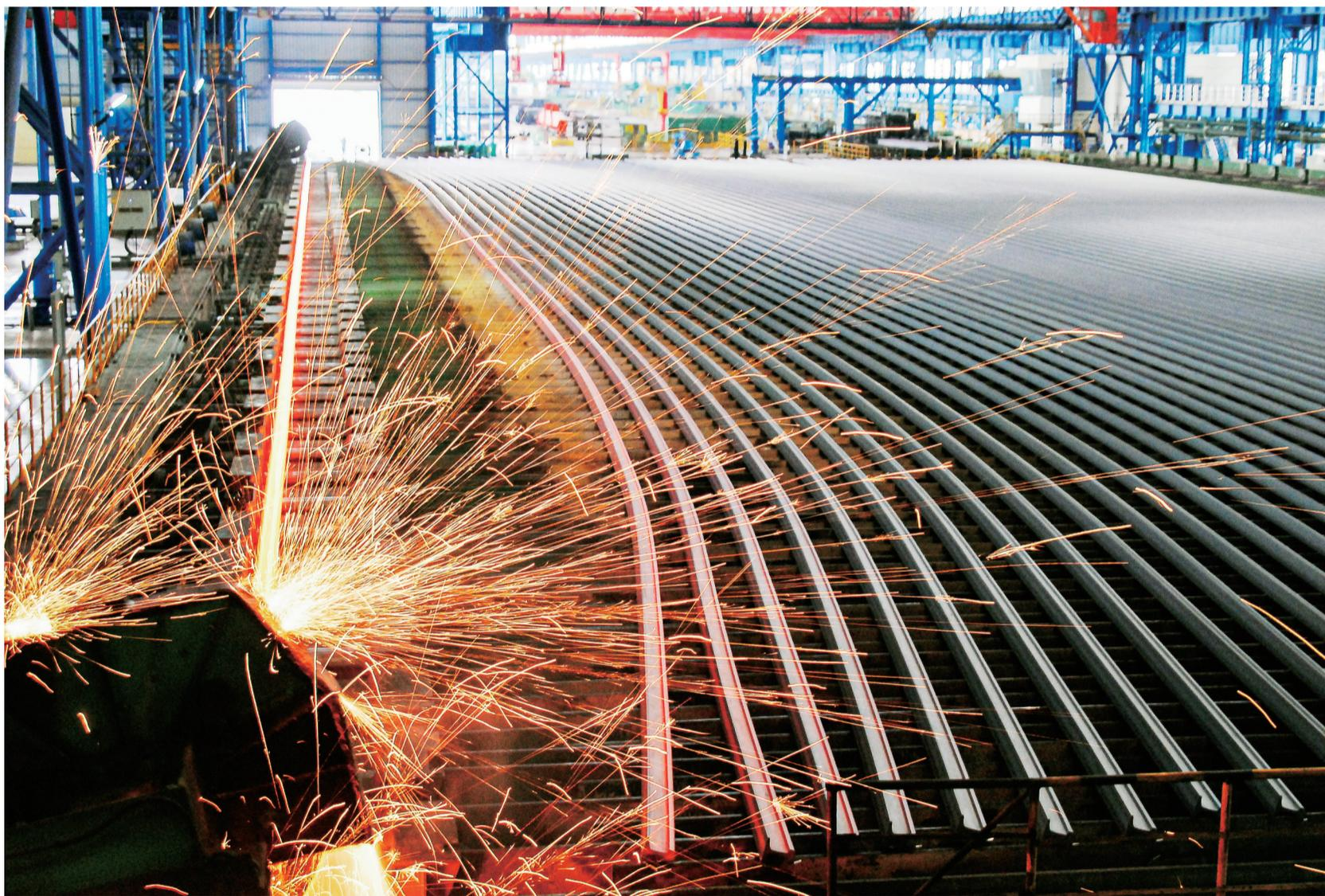
武钢有限条材厂自动化生产线,一根根高性能钢轨不断快速产出。
