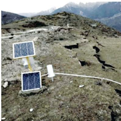
我国自主研发的位移器裂缝器。
