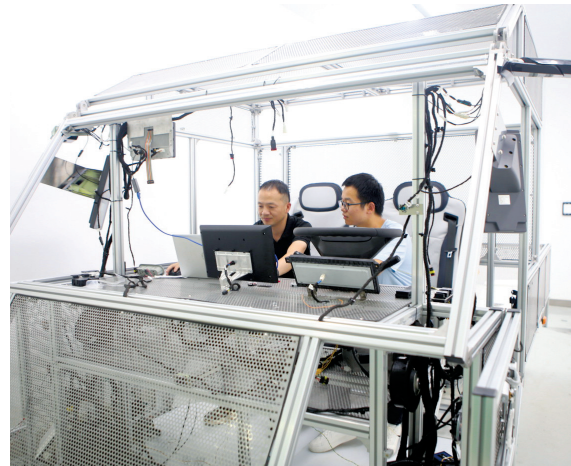
△海珀特武汉研发中心试验区,技术人员正在做电子后视镜系统测试。
