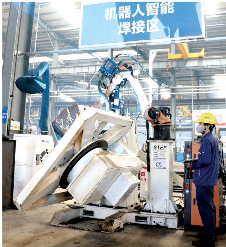
武汉铁塔公司的焊接机器人正舞动机械臂,焊接起两块金属板。
