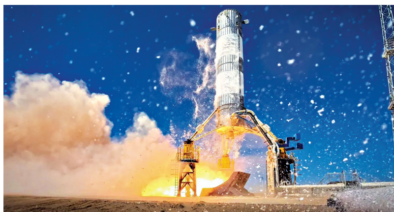
朱雀三号VTVL-1可重复使用垂直起降回收试验箭。（蓝箭航天供图）
