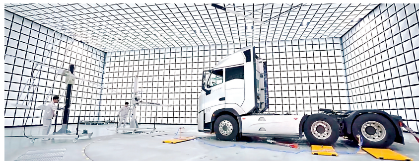
中汽研汽车检验中心(武汉)有限公司内,电磁兼容试验室正在检测车辆在电磁环境下的性能。
