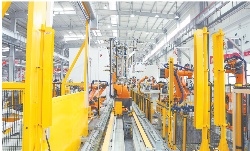
调试中的全自动新能源汽车铝合金电池托盘产线。
