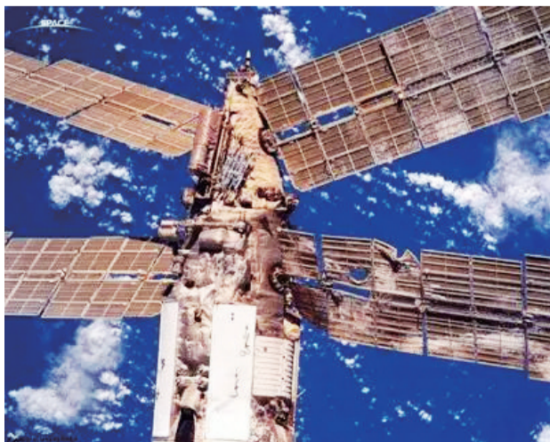
前苏联“和平”号空间站太阳能帆板被碎片撞成这副样子。
