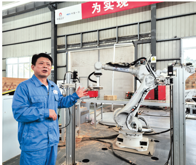
吴春桥介绍砌筑机器人,目前该机器人还需要人工辅助操作。 记者刘克取 摄
