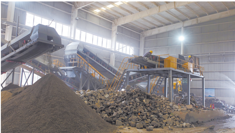
建筑垃圾通过各类设备逐级筛选分离。 记者何晓刚 摄 颗粒原料从传送带上输送到地面,待转运再利用。 在东西湖区,每日平均产生的装修垃圾量约为200吨。“来源广泛、分布零散、单次产量不高、成分复杂。”城管 执法队员王晓军坦言,由于缺乏专门的建筑垃圾处理设施,建筑垃圾“难收运、难消纳、难处理”。 今年,运营建筑垃圾处置厂的湖北智拓天鑫再生资源有限公司通过添
