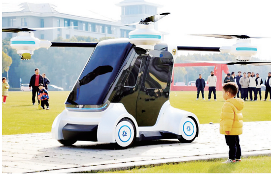
“东大·鲲鹏1号”飞行汽车是国内首辆全轮转向全轮驱动、四轴八桨构型飞行汽车。
