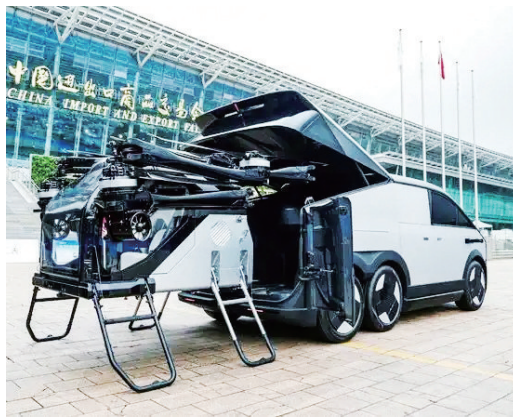
△“陆地航母”分为陆行体和飞行体两部分,飞行体能装进陆行体后备舱。
