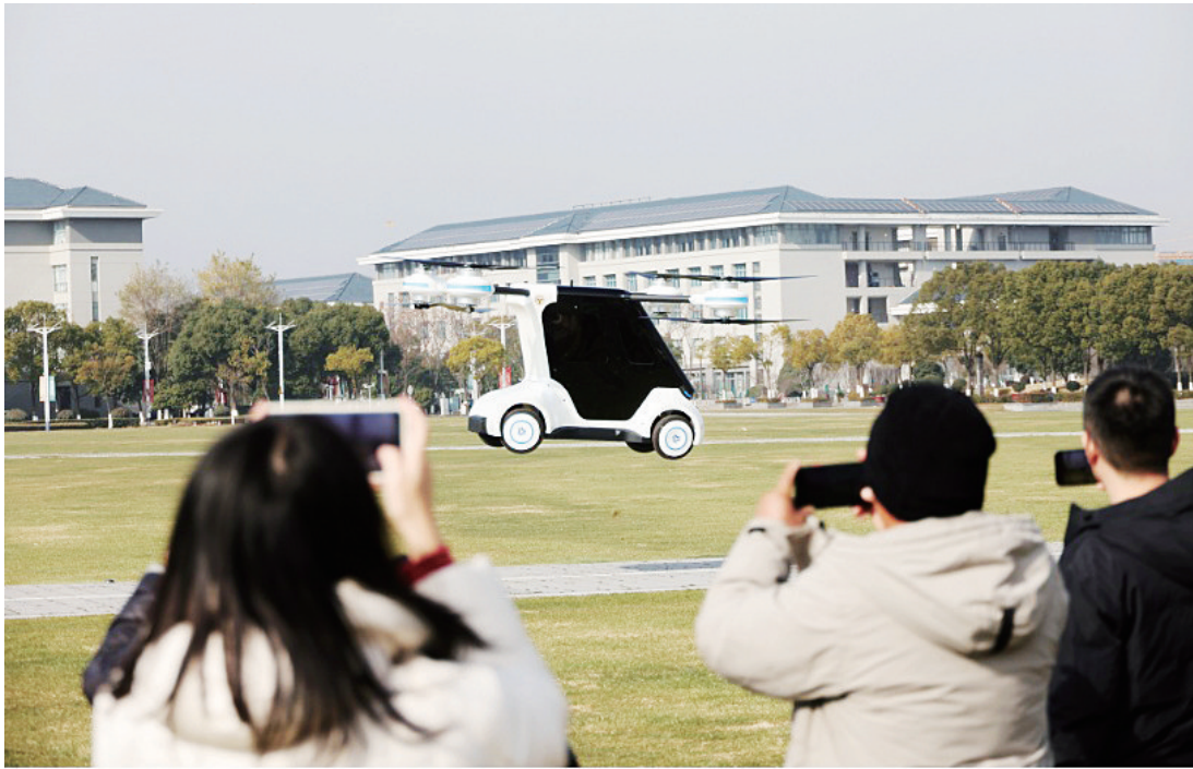
“东大·鲲鹏1号”飞行汽车是国内首辆全轮转向全轮驱动、四轴八桨构型飞行汽车。
