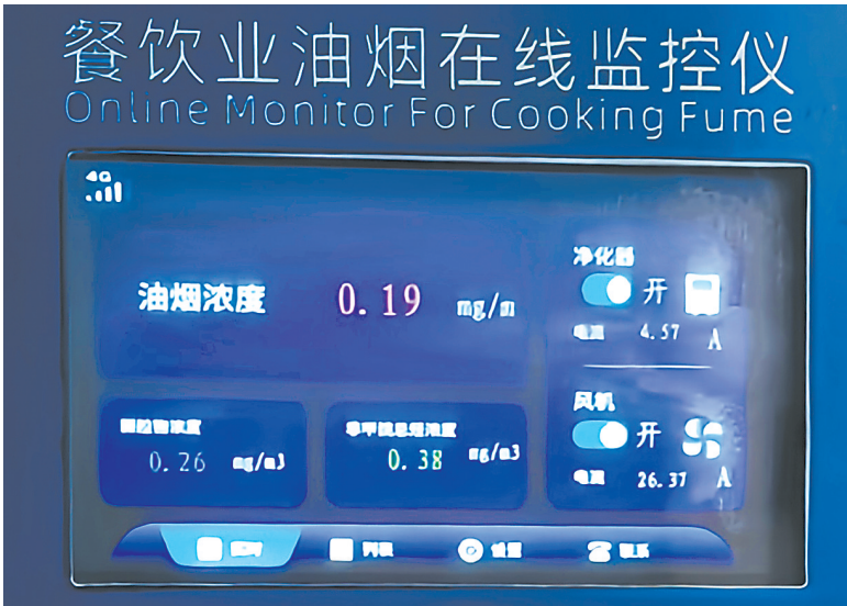
安装在油烟排放口的传感器,能够实时监测油烟的浓度、温度、湿度等数据。
