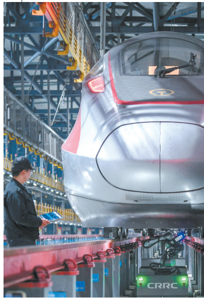
1月13日晚,地勤机械师张东浩正在使用巡检机器人对动车组“问诊”。…… 记者史伟 摄
