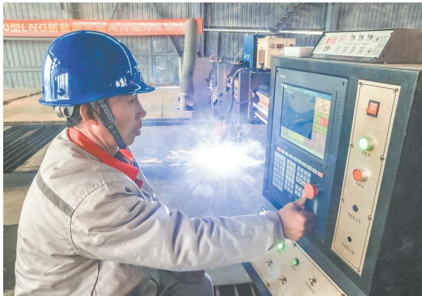
生产车间,数控切割机正在运行,技术员使用操控台控制激光功率。
