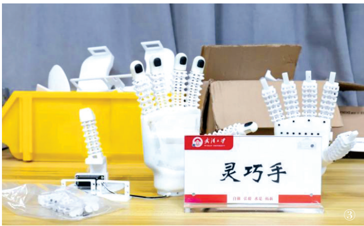
① “天问”机器人1号。 ② “天问”机器人2号。 ③ “天问”机器人的灵巧手。
