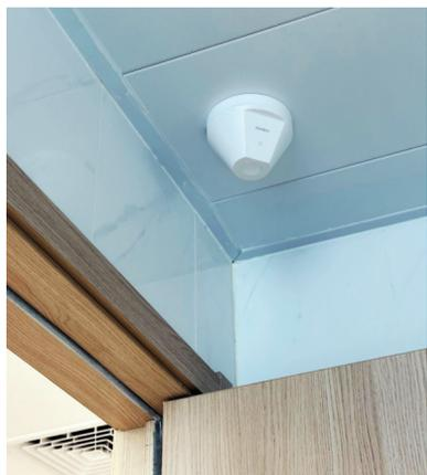
墙上安装的毫米波雷达监测老人是否跌倒。
