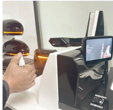
△对着电子外后视镜喷水雾,显示屏依旧清晰。
