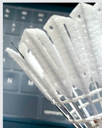
击打后的碳音球毛杆处露出了较硬的线体。
