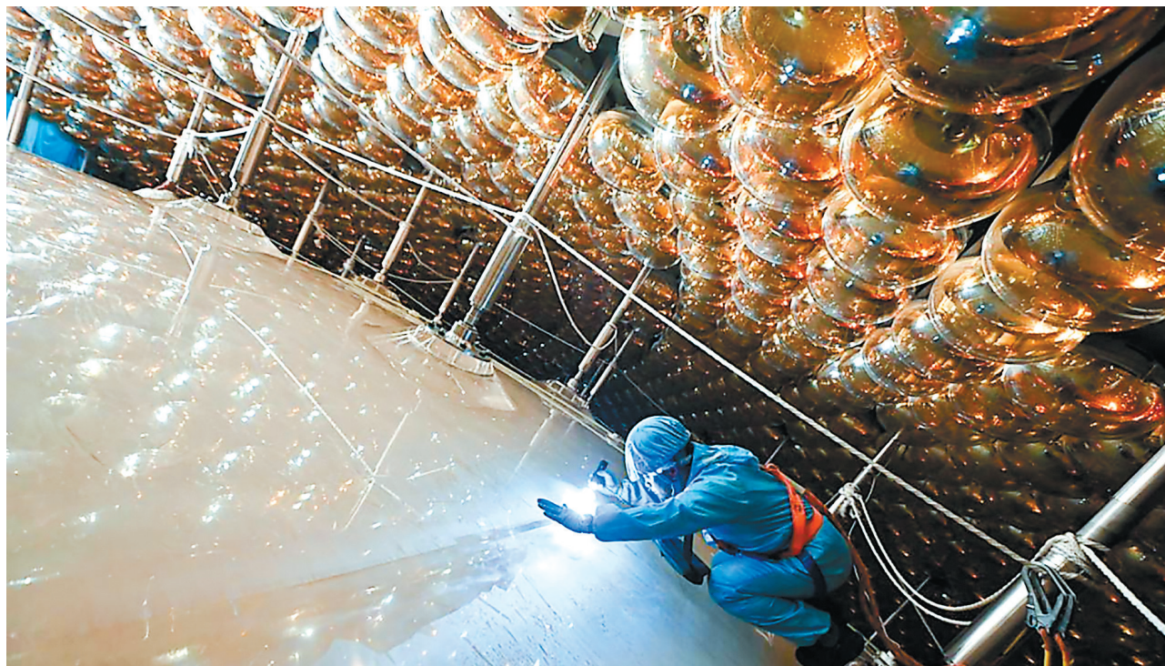
中心探测器内部的有机玻璃球及光电倍增管。
