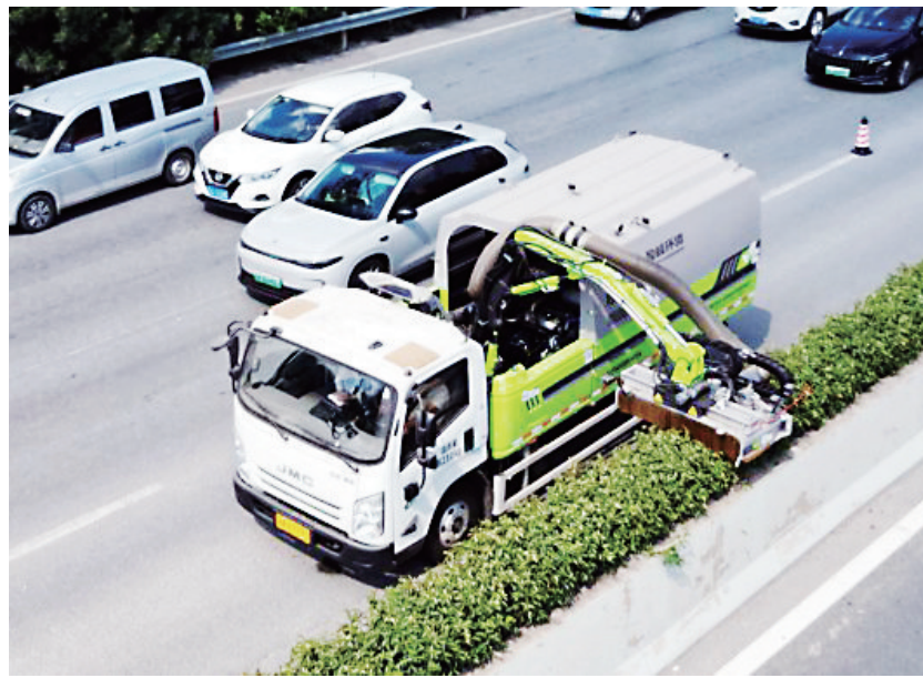
全自动绿篱修剪车正在修剪中分带绿篱。
