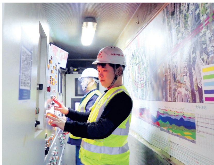
10月31日,武汉地铁12号线右线隧道内,盾构机操作手正在操作设备。 通讯员李晓旭 摄
