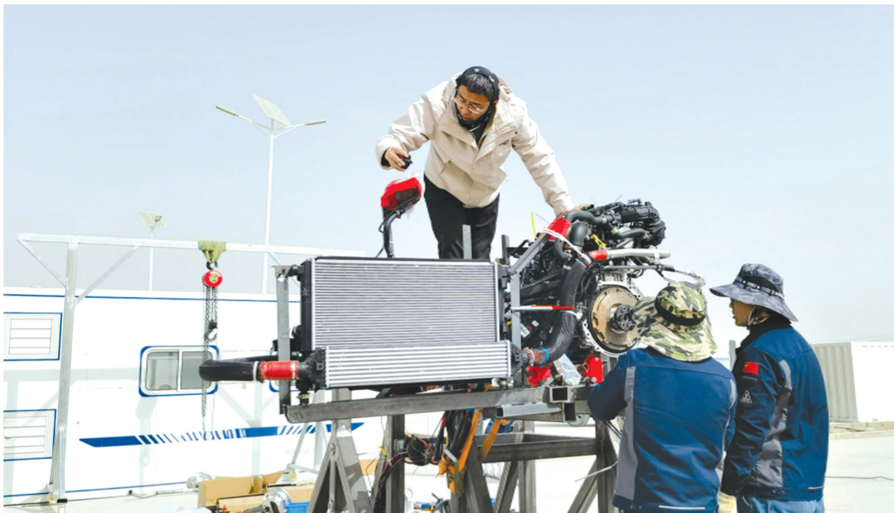
今年4月,东风马赫动力1.5TD高性能发动机率先完成首个低空无人机项目地面大功率联调。通讯员供图
