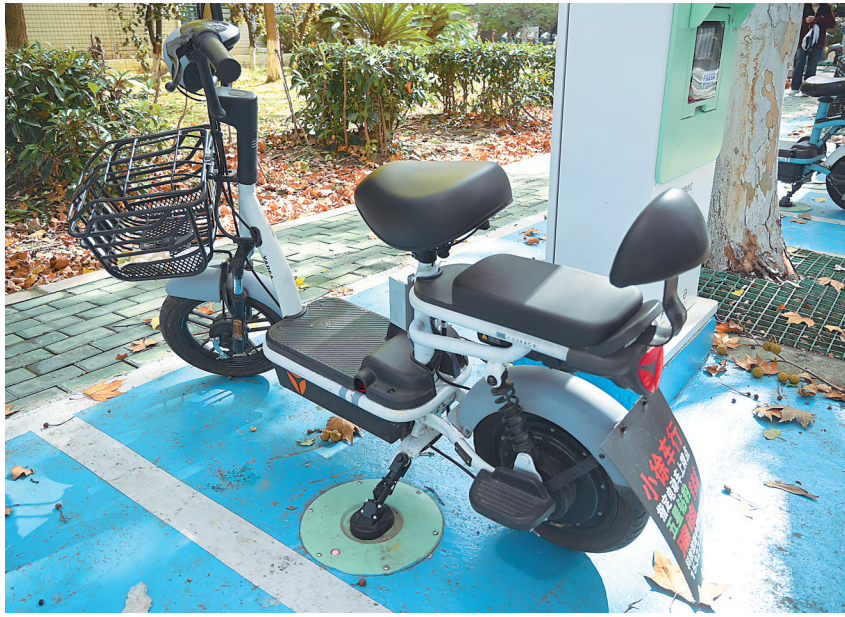
停车时将特制脚撑放入托盘,便可以自动充电。 记者郝天娇 摄
