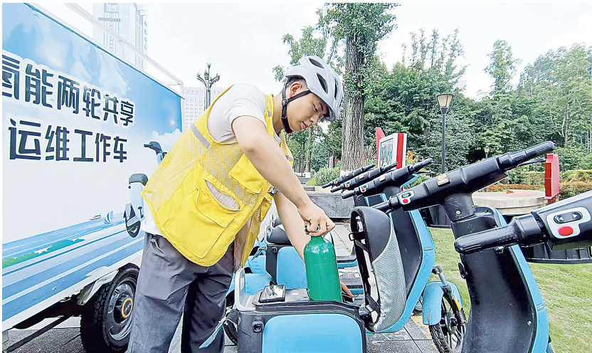
技术人员在维护固态储氢瓶。
