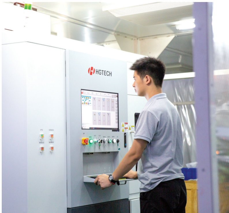
华工激光工程师正在晶圆激光精密切割平台开展样品加工调试。受访方供图
